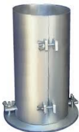
Fig. 8.2 Molde de acero, para elaboración de probetas de ensayo
