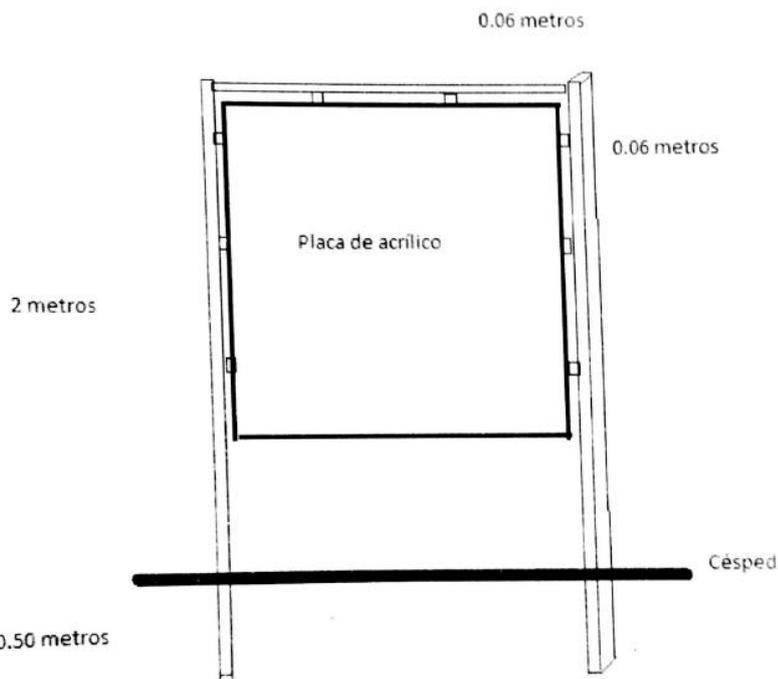
Esquema de referencia del soporte metálico para placa de acrílico (visualización del Templete)
