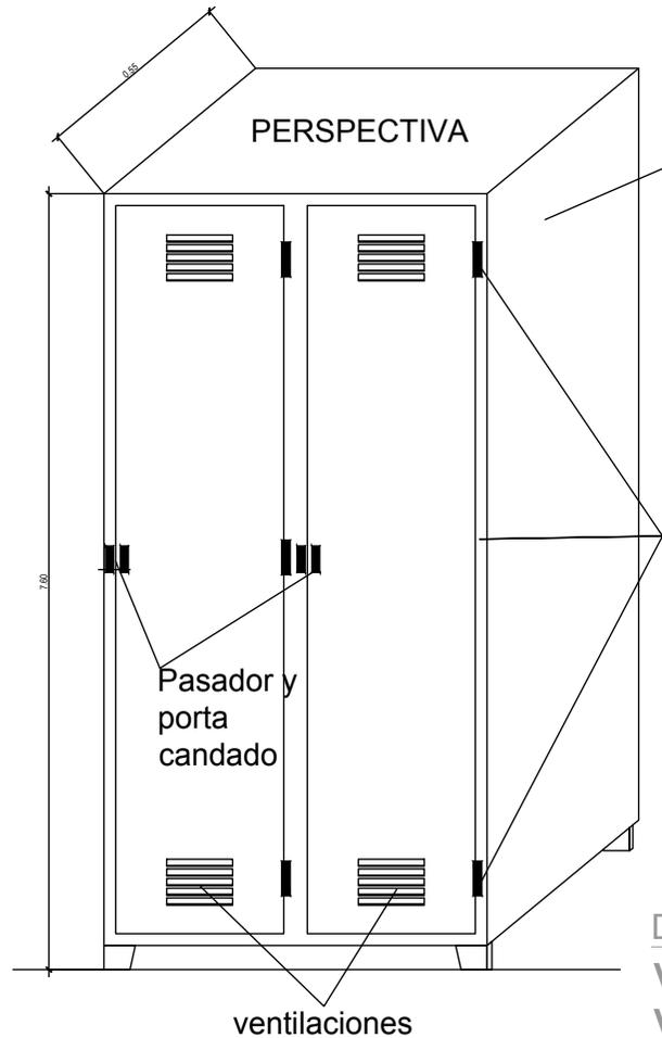
**LOCKERS:** contruídos en su totalidad en chapa de acero reforzado, laminado en frío, espesor 1.25 mm con patas sanitarias. Terminación con pintura tipo esmalte sintético antioxido 2 en 1, color gris hielo.
